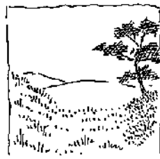
Вертикальная штриховка обозначает траву, одновременно показывает рельеф местности
